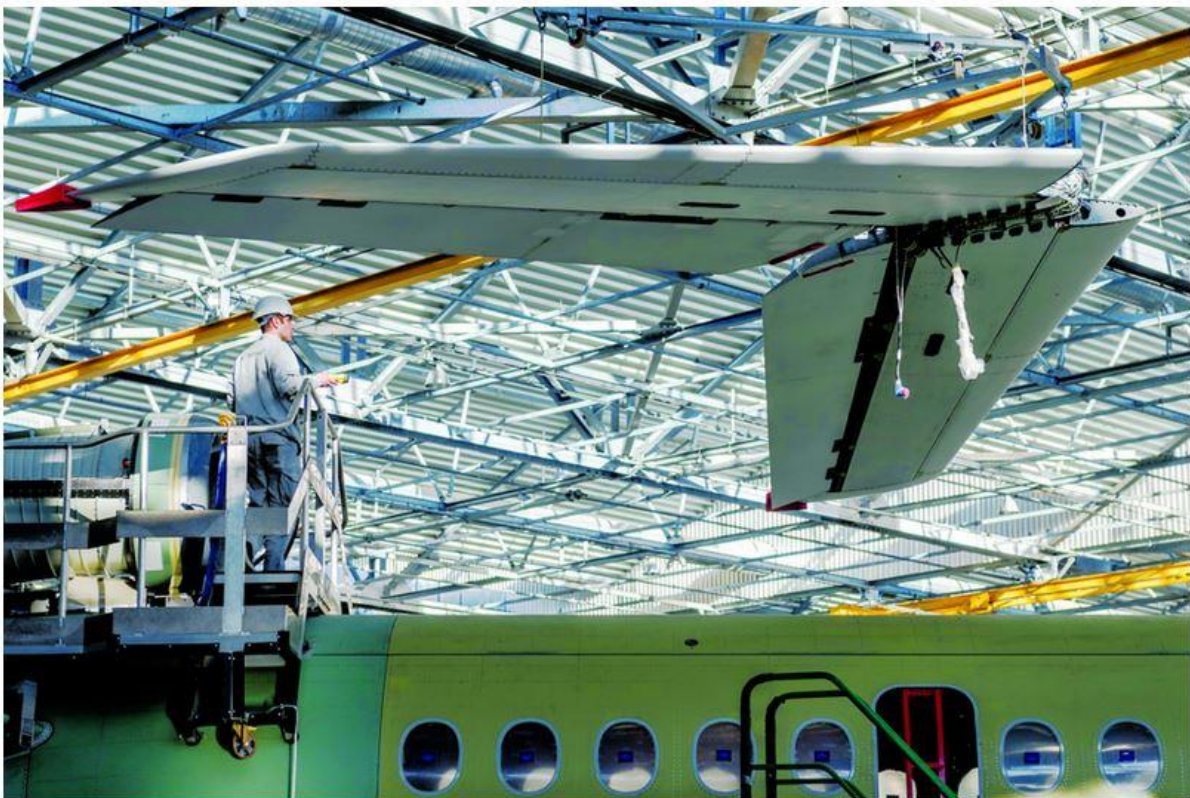
Montage de l'empennage horizontal d'un Falcon 8X, à Mérignac (Gironde).
